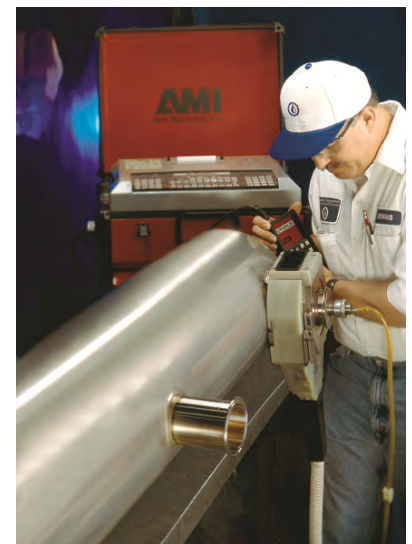
Posicionamiento del cabezal sobre tubo en "T"
