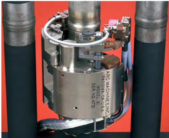
El cabezal AMI modelo 81 comporta todas las funciones para la soldadura de tuberías, tales como: control programable de la tensión del arco (AVC), oscilación de la torcha y bobina de hilo incorporada.
