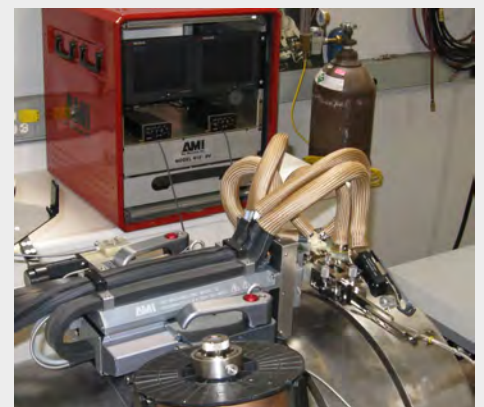
Soldadura Narrow-Gap con Video
