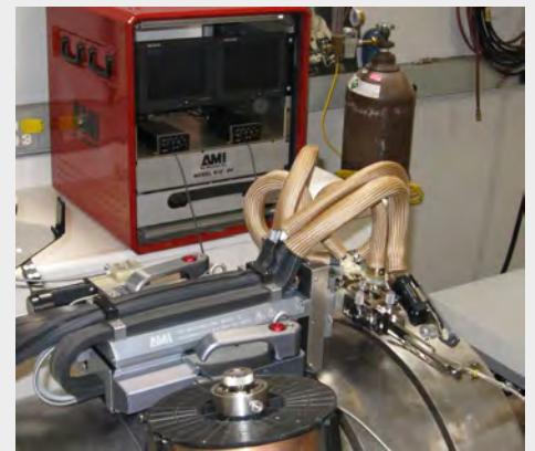
Spawanie wąskoszczelinowe z Systemem Wizyjnym
