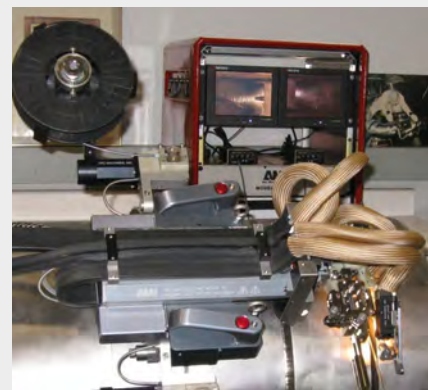
Saldatura Narrow-Gap con Visione
