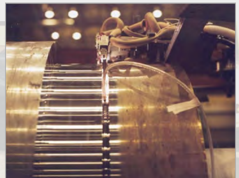
Saldatura della giunzione su un rotore di turbina di vapore
