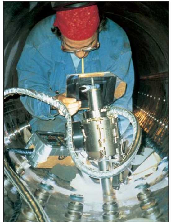
Soudage à l'intérieur d'un réservoir avec le modèle 81 et l'option kit d'inclinaison torche.
